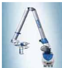
3Dスキャナ 装置仕様 Faro Edge ScanArm ES (FARO社) 性能:非接触式スキャナ(光切断方式) 精度:±35μm スキャンレンジ:80~165mm(測定深さ方向)
