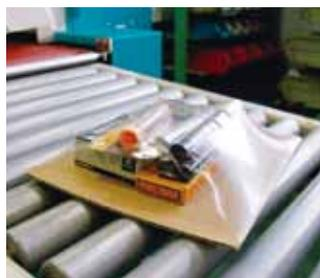
加熱収縮により透明フィルムを密着させた、シュリンク包装後の商品
