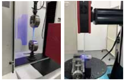
図2 測定風景 (左:物性評価 右:留め具のひずみ計測)
