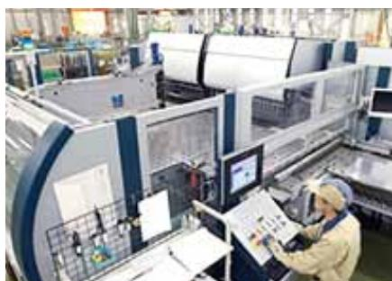
工場内は、標準化されたユニットとモジュールの組み合わせによる超多品種なサプライヤ体制を構築。受注にリンクした効率的な生産を行うための、生産ITシステムを駆使した生産ラインが確立され、2017年度の環境試験器の生産実績は、226種類、9,973台／年に達しました。
