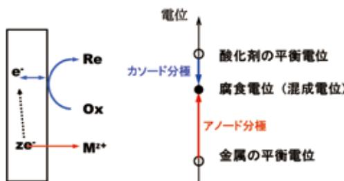
図2 腐食反応の成立条件
