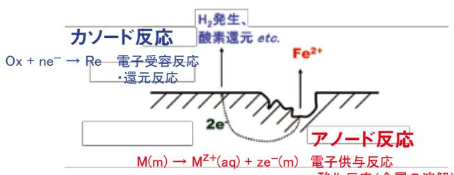
図1 腐食現象の模式図
