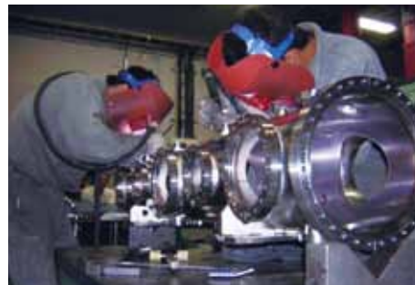
気密溶接作業
