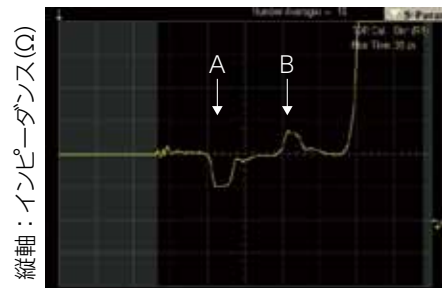
図2 デモボードのTDR測定グラフ
