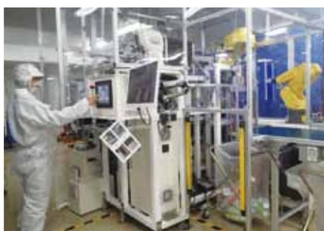
生産状況可視化共有システムによる製品外観検査
