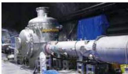
「KAGRA」の冷却装置(東京大学宇宙線研究所 写真提供) マイナス200℃以上をキープする断熱性が求められる
