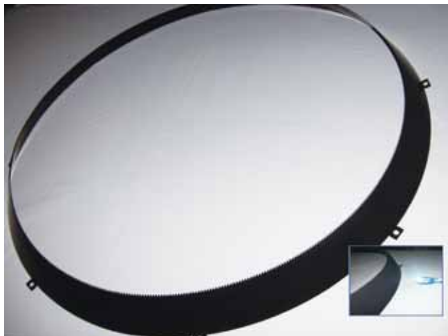
「KAGRA」の遮光板。レーザー光線の乱反射を防ぐ高い光吸収性が求められる
