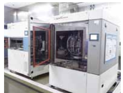
耐候性評価システム キセノンランプ式(右)、メタルハライドランプ式(左)
