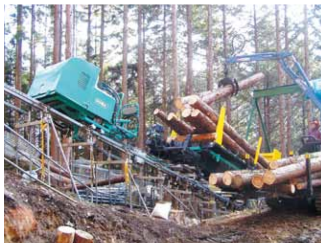
フォワードで集材した間伐材をモノレールに積み替え中
