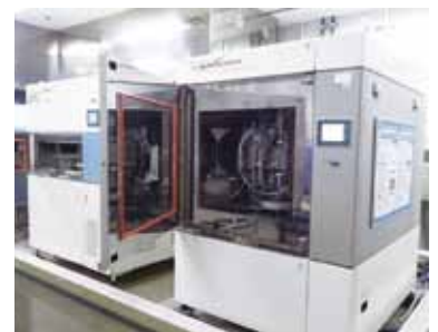
耐候性評価システム キセノンランプ式(右)、メタルハライドランプ式(左)
