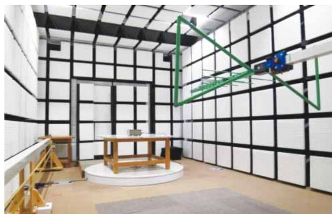
電波暗室での電磁ノイズ計測
