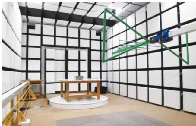
電波暗室での電磁ノイズ計測
