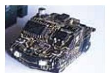
立体構造基板への実装例
