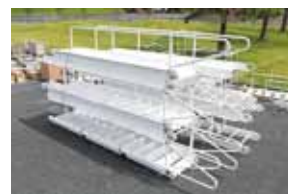
特殊な塗料を施した甲板機械(上)、傾斜梯子(下)
