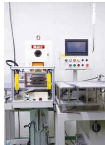
独自に開発した正極集電体の加工装置
