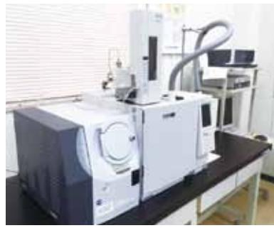
図1 ガスクロマトグラフ質量分析装置
