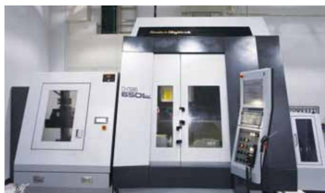
超高精度加工を実現するリニア駆動5軸加工機
