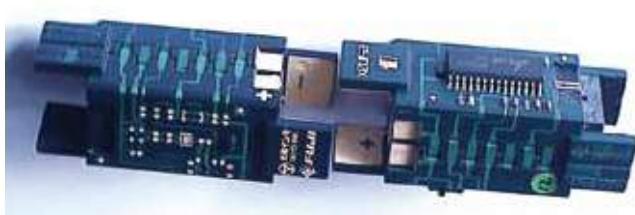
写真1 3D実装基板の例
