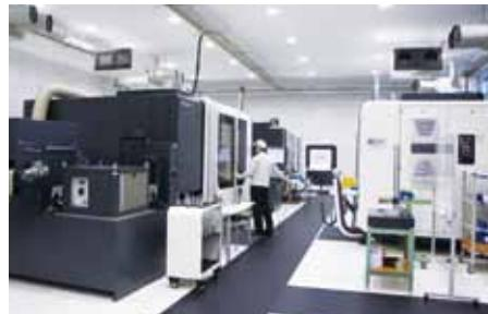
リニア駆動5軸加工機を集約した新工場。6S活動を徹底している。
