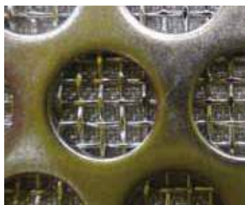
ボンメッシュ(パンチングタイプ)の拡大写真 上から、パンチングメタル、金網の3層の焼結品。
