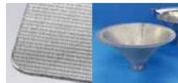
平縫織金網を2層または3層に重ねて、焼結、圧延を施し一体化。整流、粉体輸送、散気、乾燥冷却、浸透、抵抗抗体などの機能が要求される分野に対応。
