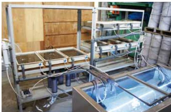
シジミ養殖するトレイと浄化槽をパイプでつなぎ、水を循環させる陸上養殖装置
