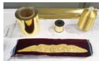
金糸製造の各段階 銀蒸着フィルム(奥)は2段階で細い紐状に裁断され(左、中)、擦糸される(右)。手前は加工品(刺繍)。
