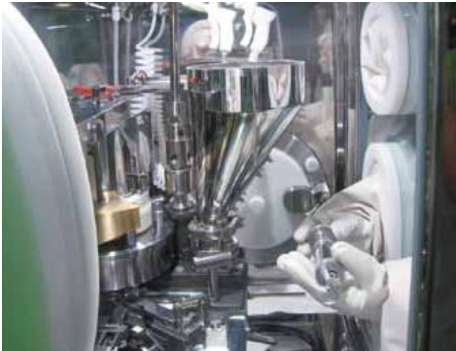
内部の調節・洗浄などの作業にはグローブを使用
