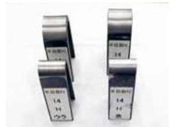
曲げ試験後の競技材
