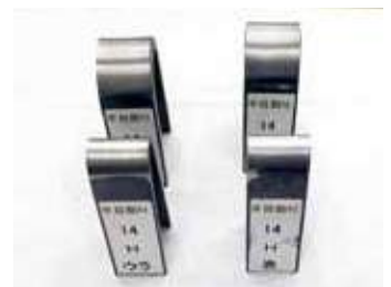
曲げ試験後の競技材
