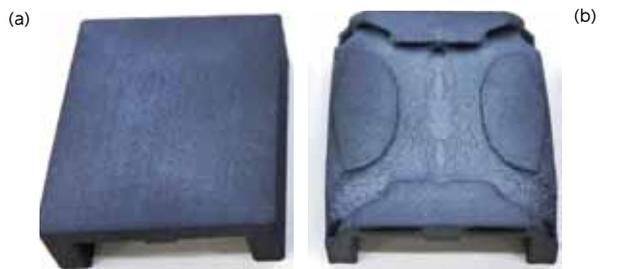
図4 樹脂粉末3Dプリンタ造形品 (a)最適化前 (b)最適化後
