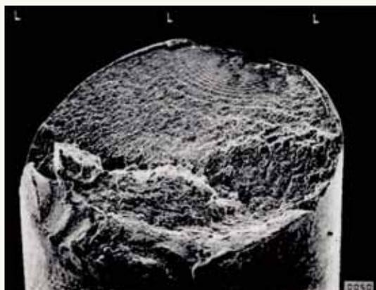
図2 軸破面の顕微鏡観察像
