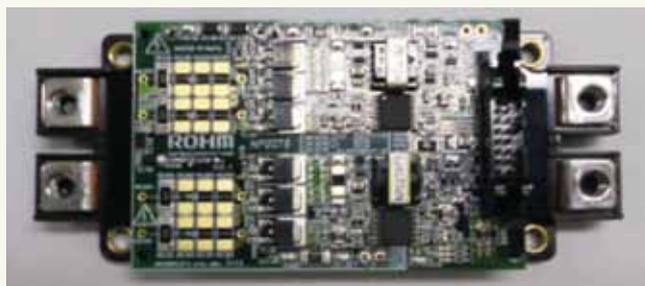
図4 SiCパワーモジュール(ROHM製,1200V,300A)
