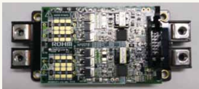
図4 SiCパワーモジュール(ROHM製,1200V,300A)
