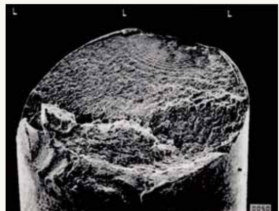
図2 軸破面の顕微鏡観察像 (破面右上部を起点に同心円上にビーチマークが見られる)
