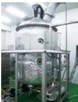
開発品-薄膜向流式の水蒸気蒸留装置 TLVC(長浜工場)(特許 第5898733号)
