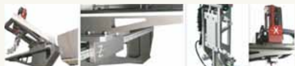
図2 トポロジー最適化を用いて開発した射出成型機用ロボット 出典：京都大学大学院工学研究科機械工学専攻生産システム工学研究室HP
