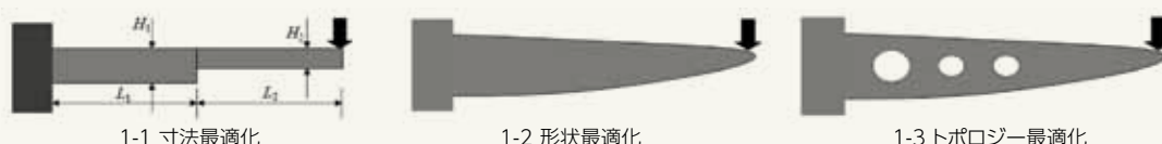
図1 構造最適化の分類概念図 出典：西脇眞二「機械設計と構造最適化」2015年11月24日講演資料
