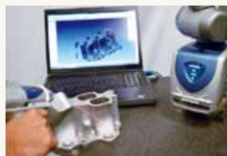
【測定例】鋳物部品の三次元データ取得
