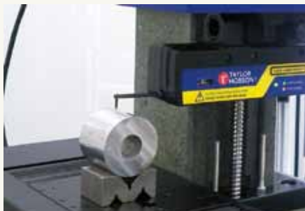
図2 触針式表面粗さ測定の例
