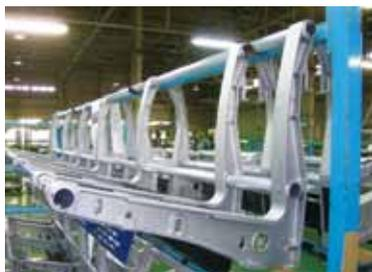
新世代ロングシートに使われているアルミダイカスト製フレーム
