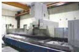
最長6mの長尺部品を加工するマシニングセンタ
