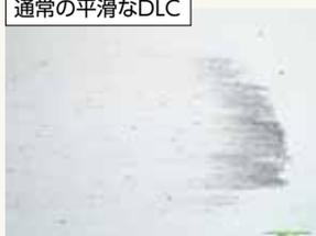
DLC断面形の変化や研磨性粒子を捕捉する凹部が増えるためメッシュサイズが小さくなるに従い摩擦係数は低下しています。
