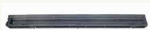
当センター高速三次元成形機で試作した、ライン光源を組み込む部品黒色の造形品が得られるため、光学部品筐体に適しています。
