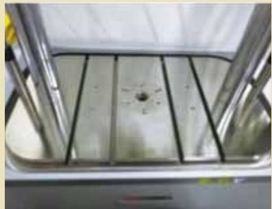
恒温槽を付属し、-30°Cから200°Cの温度環境下での試験が行えます。
