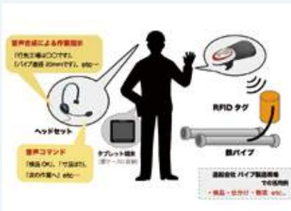
造船会社で鉄パイプを管理する際、メッキで品番が消えたものを人手で仕訳していたために間違いが発生し、多くのパイプを無駄にしていました。そこでパイプにタグを付けて、TECCOで認
