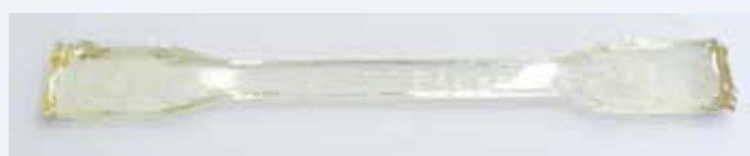
図1 ラピッドプロトタイピング簡易型を用いた引張強度試験片成型品写真
