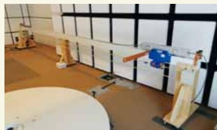
自動走行式の妨害電力測定システム(新規)
