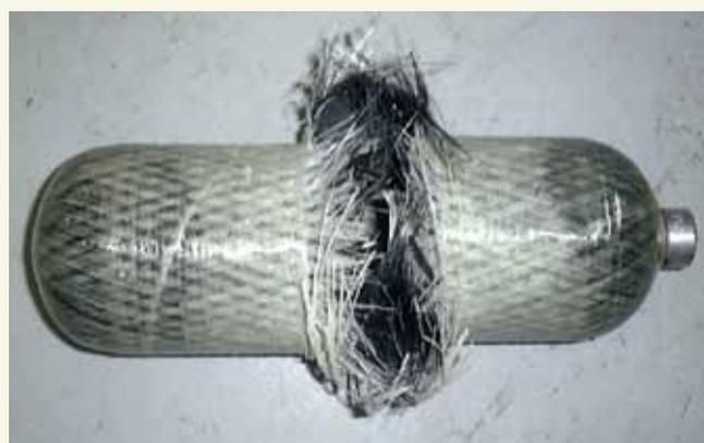
圧力容器の破損の様子
