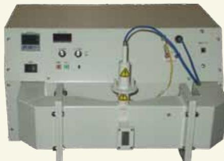
〈マイクロ波化学反応装置〉
