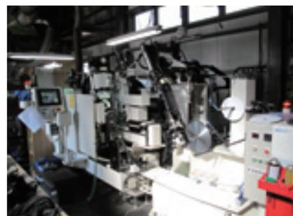
供給装置付きチップソー全自動研磨機
