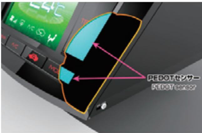
車のヒーターコントロールパネルのスイッチ部を従来のメカスイッチから静電容量スイッチに変更。
