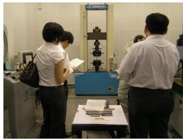
私達の身の回りでは様々な材料が使用されていますが、それらが使用に対して適切な強さを持っているかどうかを調べる最も基本的な方法が「引張試験」です。実際に鉄やアルミなどの金属材料を引張って、強さや変形の様子を調べてみましょう。
