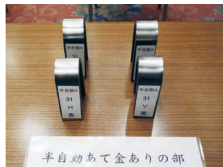
溶接接合部の曲げ試験の概観 審査では、小さな傷も減点対象となる
