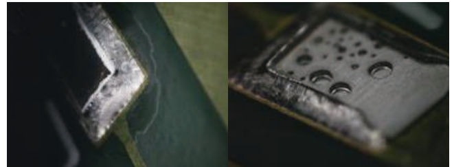
フラックス残渣とフィレット形状不良
