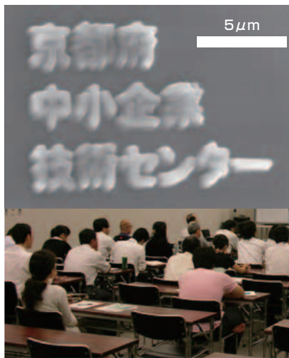
左図は、FIB(電子線ビーム)により加工された文字の電子顕微鏡像。協力:伯東(株)
