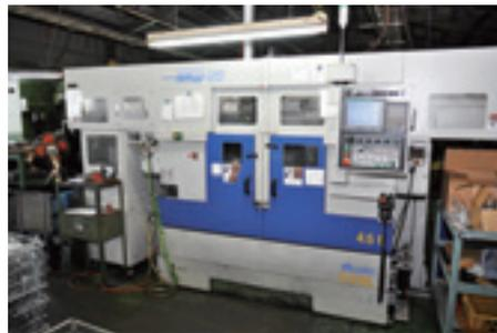
▲今回導入した平行2軸CNC旋盤
