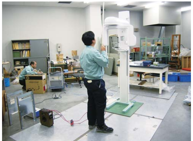
図2 電気機器への磁界印加試験の様子
