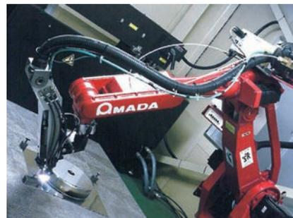
▲YAGレーザー溶接機
