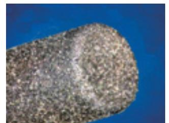
図4. 電着ダイヤモンドを施した工具
