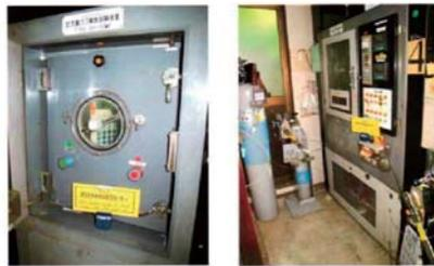
図1 環境汚染混合ガス試験装置及び処理条件
