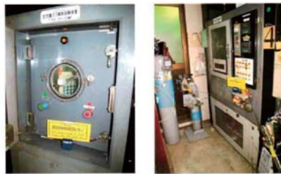
図1 環境汚染混合ガス試験装置及び処理条件 ・試験内容 3種混合耐ガス試験【H 2 S+SO 2 +NO 2 】 ・試験装置(株)山崎精機研究所 定流量フロー形ガス腐食試験装置GH-180形 ・試験条件 試験ガス・濃度 H 2 S=5ppm、NO 2 =10ppm、SO 2 =10ppm 試験温度・湿度 30.0℃・90%RH 試験日数・時間 4日間【96h】
